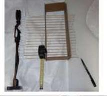
A l'aide d'un stylo, reporter sur la mousse de calage la contre-forme de l'objet (le stylo étant éloigné de l'objet, il n'y a aucun risque de marque de stylo sur l'objet)
