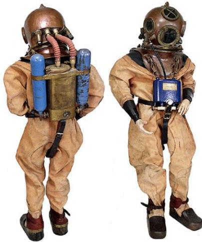
Cette firme allemande met au point un équipement innovant : le scaphandrier, autonome, utilise pour respirer deux bouteilles gonflées à 200 bars fixées dans son dos. L'air passe par un manodétendeur et un injecteur, ce qui permet de créer une circulation d'air dans le casque et d'évacuer l'air vicié dans une cartouche de soude qui piège le CO<sub>2</sub>. Le plongeur a de plus accès à une source d'air de secours qu'il garde sur sa poitrine. Cet équipement permet à des plongeurs de travailler
