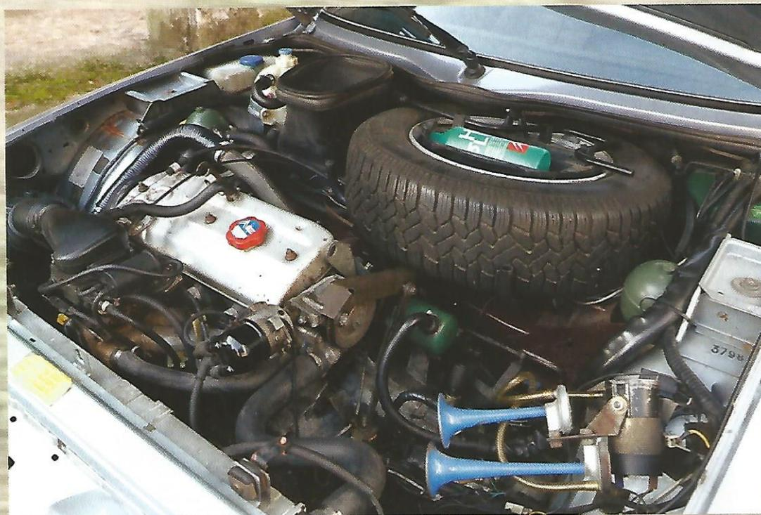
Comme les Reflex, Athena et 20, les « 22 » sont boudées pour leur moteur, développé par la Française de Mécanique et de conception Renault. C'est un tort : moderne (arbre à cames en tête), plus à l'aise dans les tours que le bloc Citroën, il offre une belle fiabilité. Portant le type « J6T A500 », il délivre 115 ch. On le verra aussi sur break 22 RS et CX Évasion essence de 1987 à 1991.
