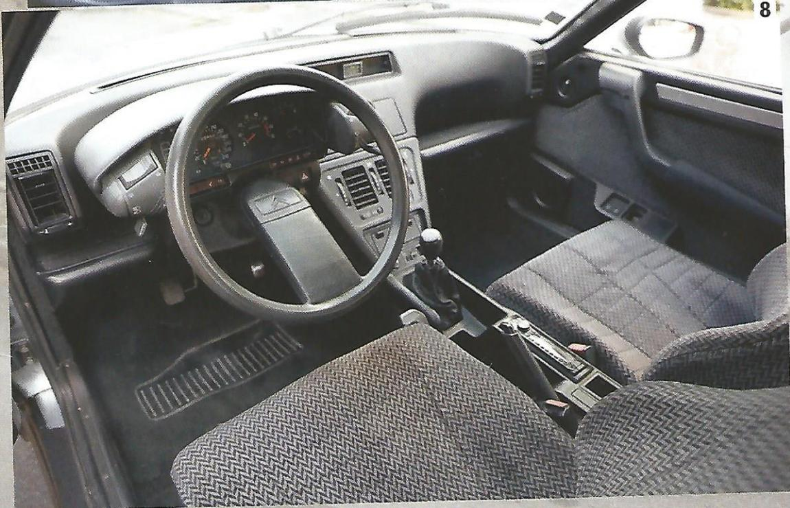
7. La première CX à instrumentation à aiguilles reste la GTI Turbo. En revanche, la silhouette indiquant le fonctionnement des lampes et la fermeture des ouvrants débute sur Série 2, à partir des finitions « TR ».
