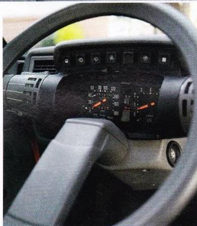
Parmi les rares réels partages avec la Visa, ces interrupteurs carrés au-dessus du bloc instruments. Et les aiguilles des compteurs!
