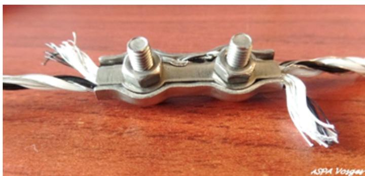
Arrivé à la fin du carton, il faut raccorder le fil de ce carton avec le fil du nouveau carton à l'aide de l'agrafe de jonction en inox et serrer très fort avec une clé plate de 7.
