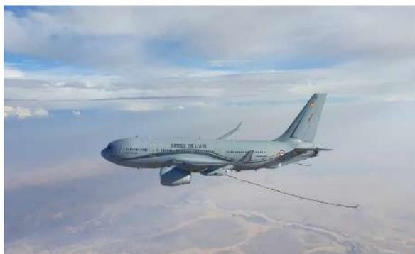
Les performances et les capacités d'emport en carburant de l'A 330 Phénix permettent d'offrir une plus grande permanence en vol aux avions de chasse qui opèrent dans la zone. Il peut assurer des ravitaillements en vol sur une zone située à 1 800 km de sa base de départ pendant trois heures à hauteur de 32 tonnes de kérosène, quand le C 135 offre des capacités de livraison de 15 tonnes durant deux heures sur la même distance.
