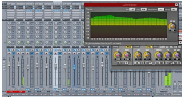
FIGURE 30 – Mesure de la corrélation entre couple et « appoint » (ici à droite), après l'introduction d'un retard temporel dédié à gauche et à droite sur le signal d'« appoint », dans l'extrait de la contrebasse.
