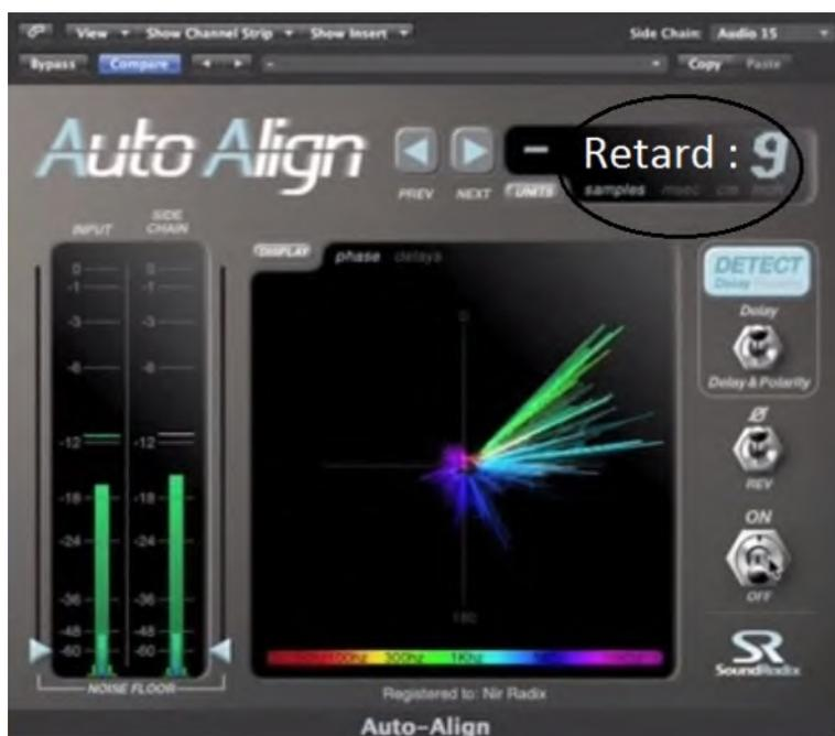
FIGURE 26 – Exemple de deux signaux déphasés de  $90^\circ$  analysés par *Auto-Align* de Sound Radix
