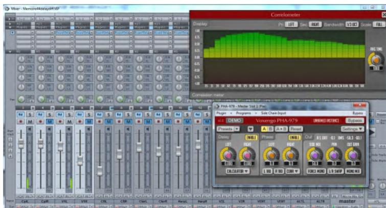
FIGURE 34 – Mesure de la corrélation entre le signal d’« appoint » des violons 1 et le canal gauche du couple, après l’introduction d’un retard temporel sur le signal d’« appoint », dans l’extrait de l’*Adagio*.
