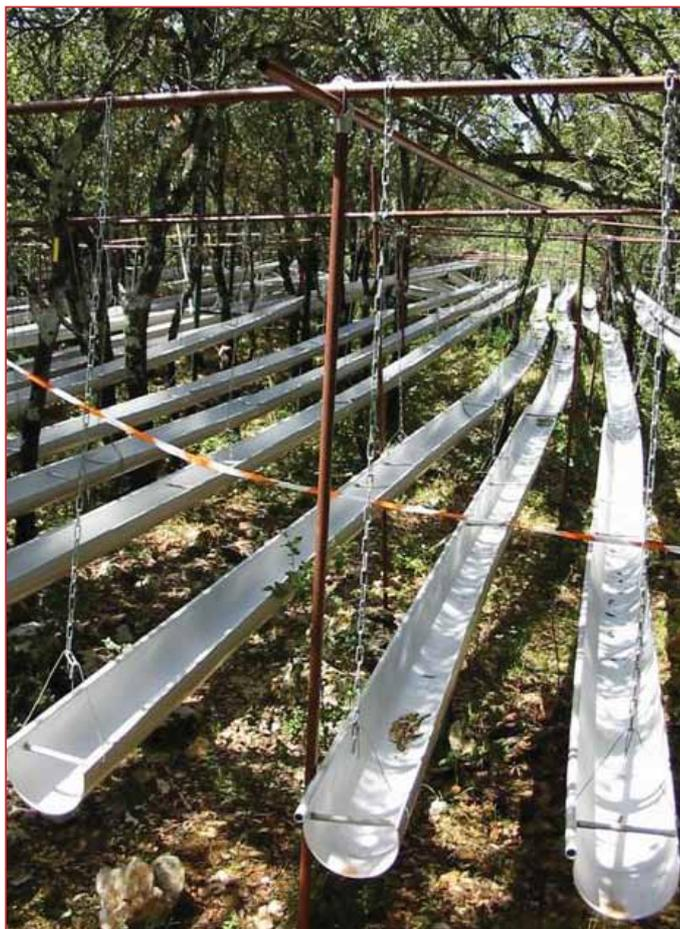
Photo 2. Dispositif d'exclusion partielle et continue de la pluie. Ce système de gouttières permet d'intercepter en continu 30% de la pluie depuis juillet 2003 sur un dispositif de 3 répétitions. Le fonctionnement de ces parcelles dites sèches est comparé à des parcelles témoins ou contrôles.
