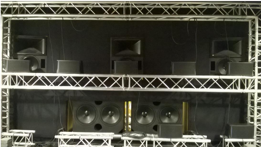
FIGURE 3.1 – *Installation des cinq enceintes APG DX8 diffusant les cinq canaux frontaux. (Les deux enceintes en bas à droite ne sont pas utilisées dans l'installation présente)*
