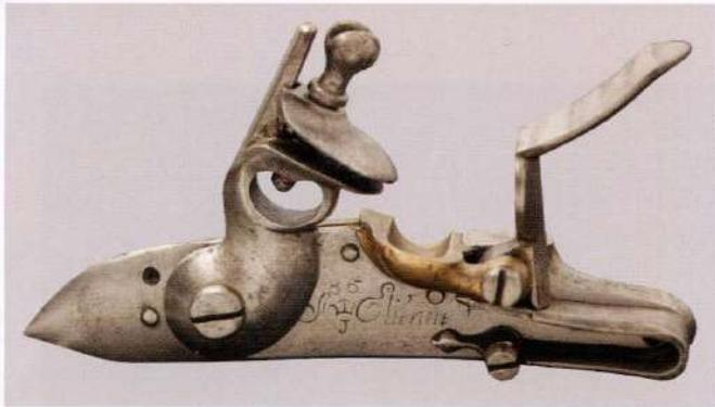
**Platine à silex du système modèle 1777**
