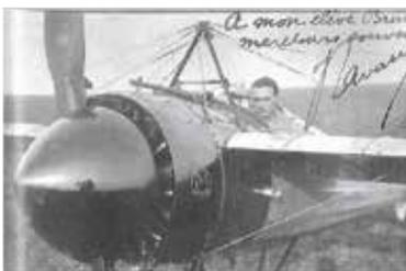
Jean Navarre sur son Morane Saulnier équipé d'une mitrailleuse. Sur l'hélice sont installés les déflecteurs du pare-balles
