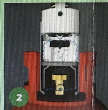
2 Mixage du mélange gazeux (turbine en circuit fermé)
