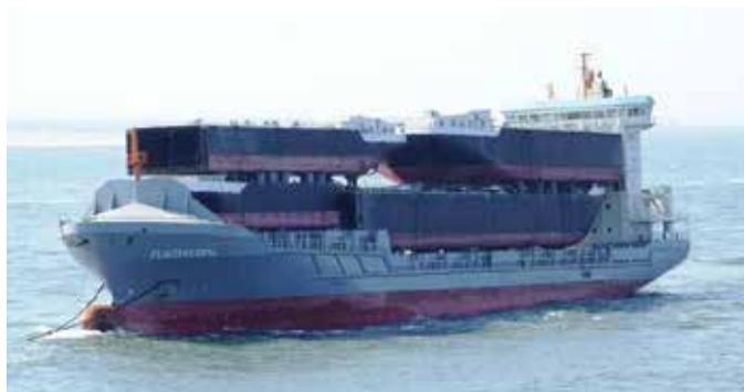
Le FlinterCoral remorqué, chargé de barges en pontée, vu dans les parages de Rotterdam en avril 2015. (Photo : MarineTraffic)
