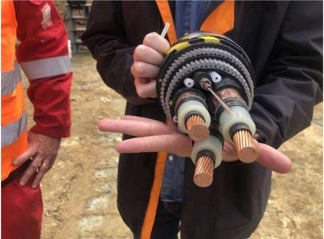
Le câble est composé d'une ligne à très haute tension capable de transporter du 20 000 volts et d'une gaine contenant 24 paires de fibre optique pour l'internet à très débit. | OUEST-FRANCE
