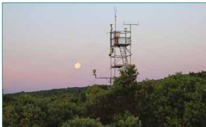
*Fig. 1 : Tour de mesure par corrélations turbulentes des flux d'énergie, d'eau et de carbone d'une forêt de chênes verts à Puechabon 50 km au nord de Montpellier
