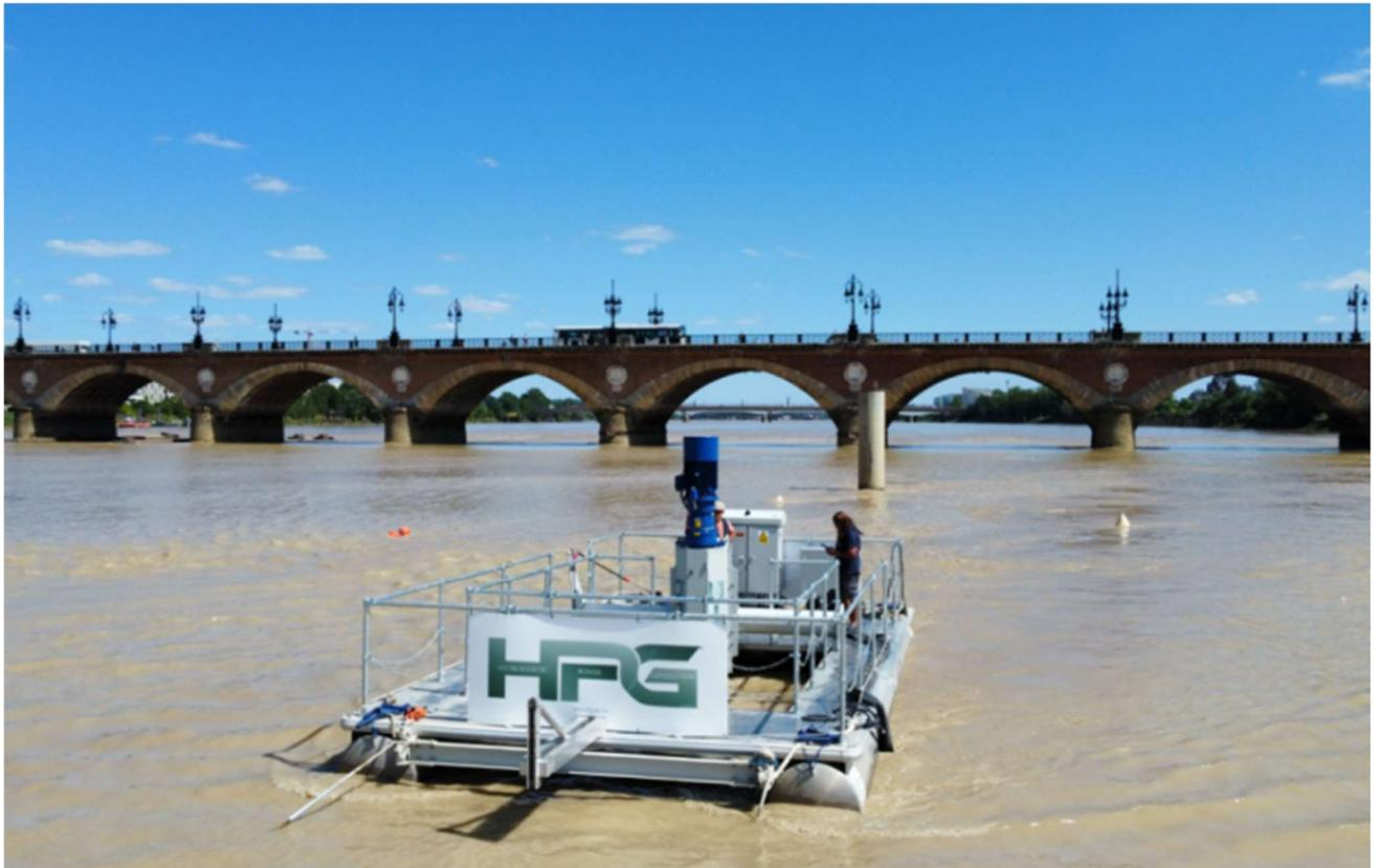
L'hydrolienne de 25 kW, sur sa plateforme flottante, a été assemblée et mise à l'eau au grand port maritime de Bordeaux avant d'être convoyée jusqu'au site Seeneoh, au pied du pont de Pierre. (Photo : Seeneoh)
