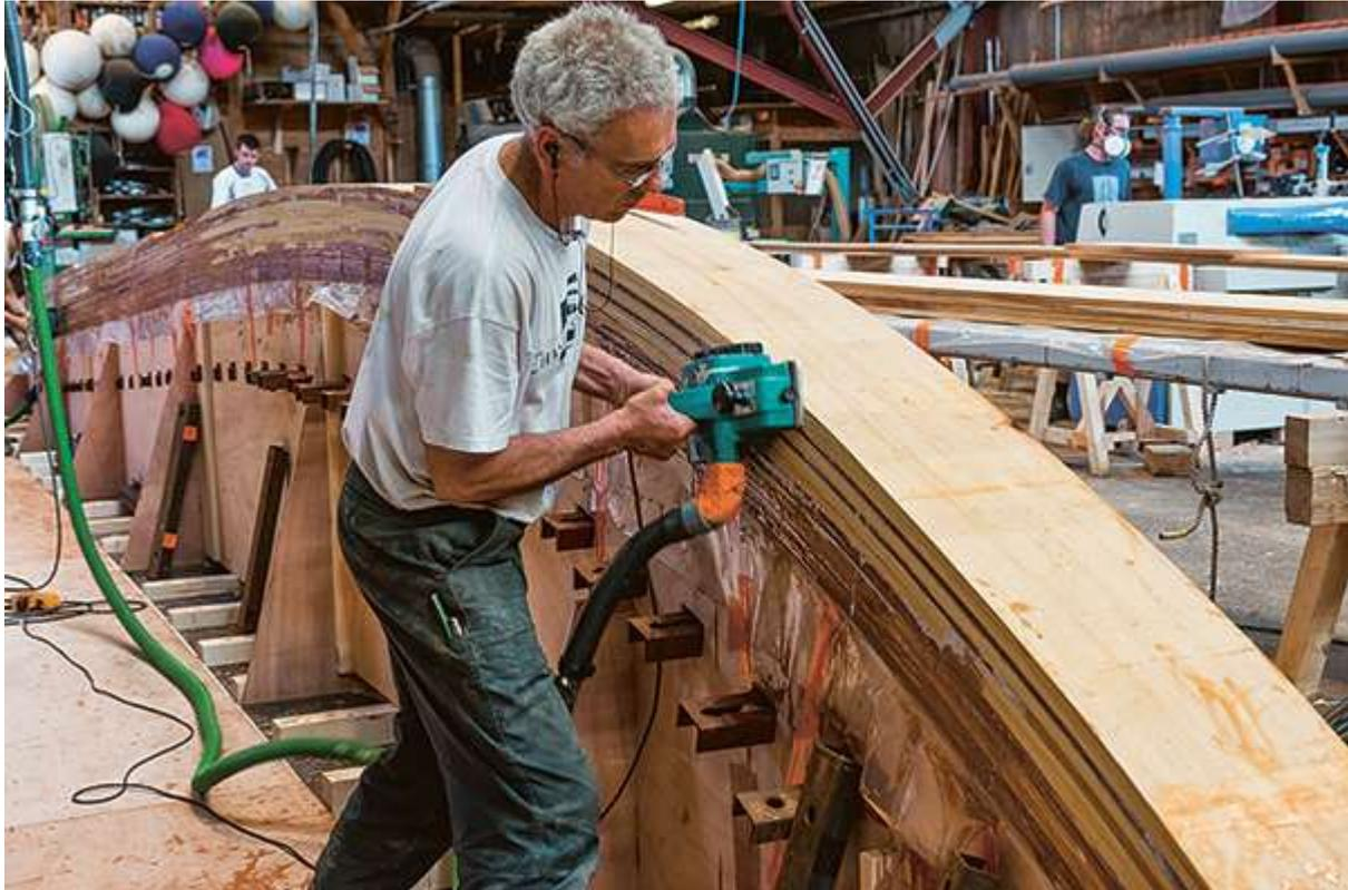
Faute de trouver une pièce de bois convenant à la réfection de l'étrave de Sumurun, celle-ci est réalisée en lamellé-collé. Les assemblages reproduisent néanmoins ceux de la construction originelle, le bois moderne étant travaillé comme une pièce massive. © Michel Le Corre
