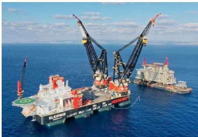
Le « Sleipnir », cheval mythique du dieu nordique Odin, est un navire aux capacités de levage hors normes (2 fois 10 000 tonnes de charge) et le premier au monde à être équipé de moteurs dual-fuel alimentés au gaz naturel liquéfié. (Photo : Heerema)
