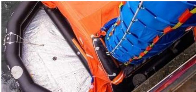
La nouvelle solution MES comprend un toboggan à sec, un radeau de sauvetage et des packs de secours pour les passagers. (Photo : Survitec)
