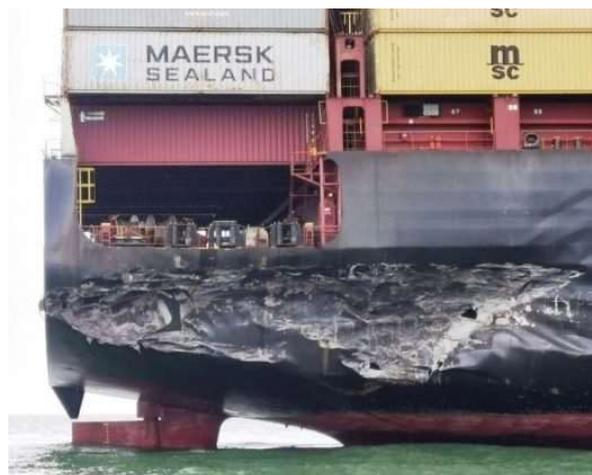
Les dégâts subis par le porte-conteneurs GSL Grania avec sa hanche tribord enfoncée au-dessus de la ligne de flottaison. La tôle est perforée à plusieurs endroits. (Photos : MMEA - Malaysian Maritime Enforcement Agency)
