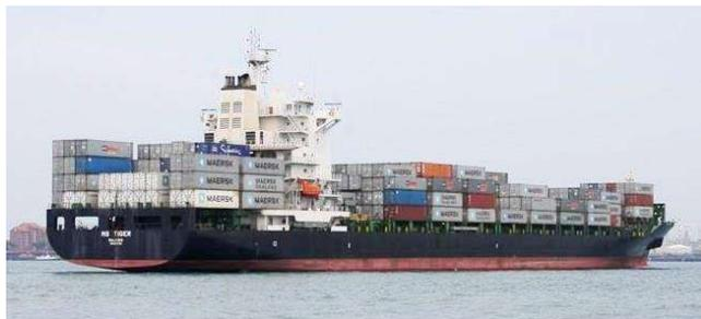
Le BF Tiger, construit en 2006, d'une capacité de 2 824 EVP, long de 222,17 m et large de 30 m, arbore le pavillon Antigua &
