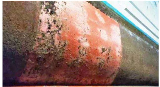
Un patch d'essai Aquaterras sur un bateau de croisière revêtu de SPC (Self-Polishing Coatings) après 20 mois d'inactivité au large de La Spezia, en Italie. L'encrassement quasi nul sur la pièce.
