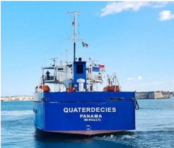
Ce caboteur, construit en 1985, ex-Arundo, a un port en lourd de 2 890 tonnes, une longueur de 87,95 m et une largeur de 11,30 m. C'était devenu une poubelle flottante.
