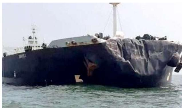
Les dégâts de l'asphaltier/bitumier Zephyr I, avec sa proue écrasée au-dessus de la ligne de flottaison.
