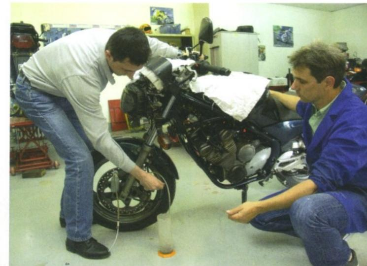
Le remplacement du liquide de frein peut virer au fiasco : la moto ne freine plus et est donc immobilisée. Le formateur provoque les erreurs classiques et donne des solutions. Du type : comment expurger facilement du circuit l'air que l'on a introduit par mégarde, en actionnant le levier bocal vide?
