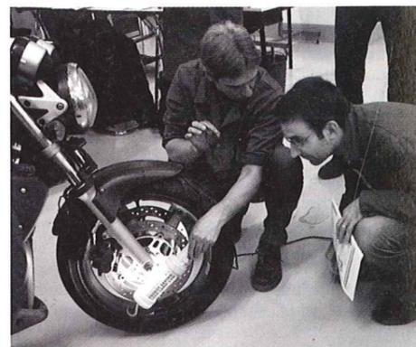
Du bon contrôle des plaquettes de frein, en s'aidant d'une lampe voire d'un miroir si besoin... Le B.A.-BA du motard et bricoleur débutant.
