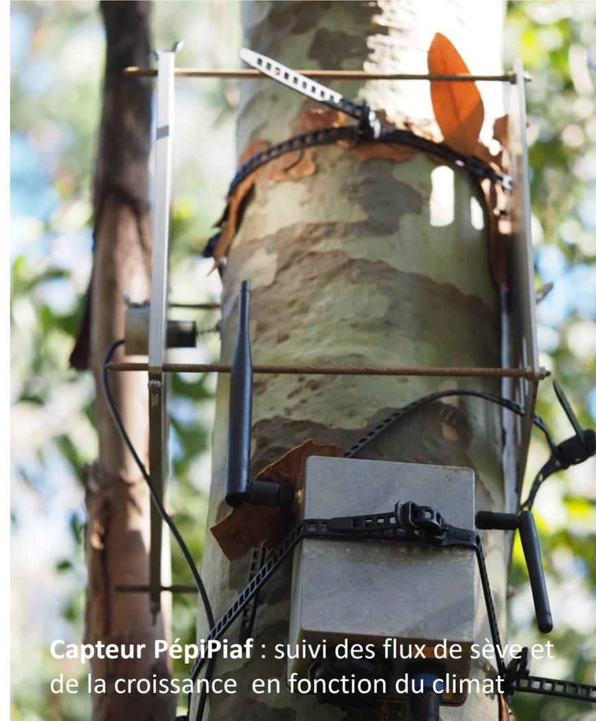
**Capteur PépiPiaf** : suivi des flux de sève et de la croissance en fonction du climat
