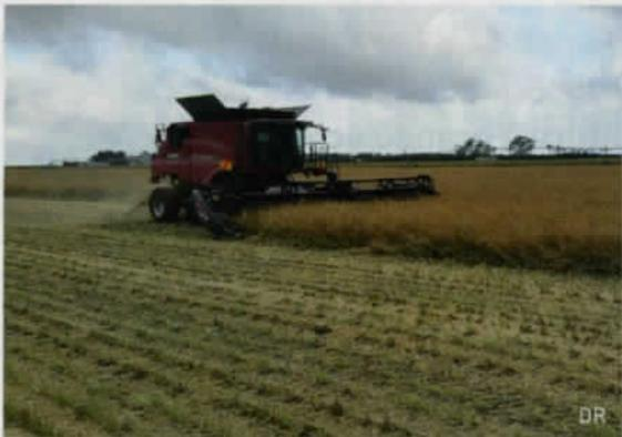
> La moissonneuse batteuse (Case IH 9230) est dotée d'une barre de coupe à tapis Mac don de 9 m de large pour mieux alimenter la machine.
