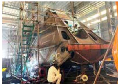
Mécanisme d'inclinaison WindWings en production.
