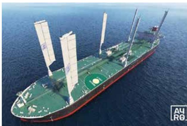
Projet de voiles Oceanwings inclinables destinées aux vraquiers et test sur un pétrolier. (Photos : Ayro)
