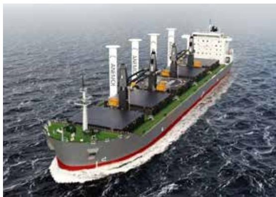
Navire équipé de 4 voiles rotors, vu de l'extérieur en hauteur et vu depuis le navire. (Photos : Marine Traffic)
