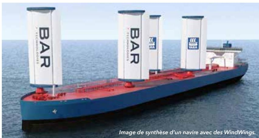
Image de synthèse d'un navire avec des WindWings.
