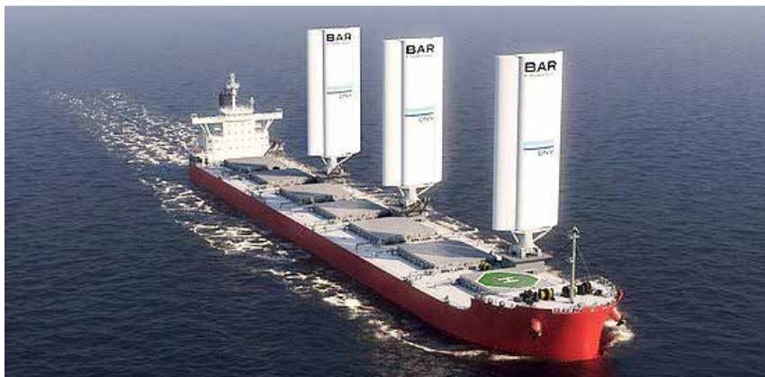
Vraquier équipé de voiles. Des moteurs auxiliaires basés sur le vent permettent d'économiser jusqu'à 20 % de carburant (Image : BAR Technologies)
