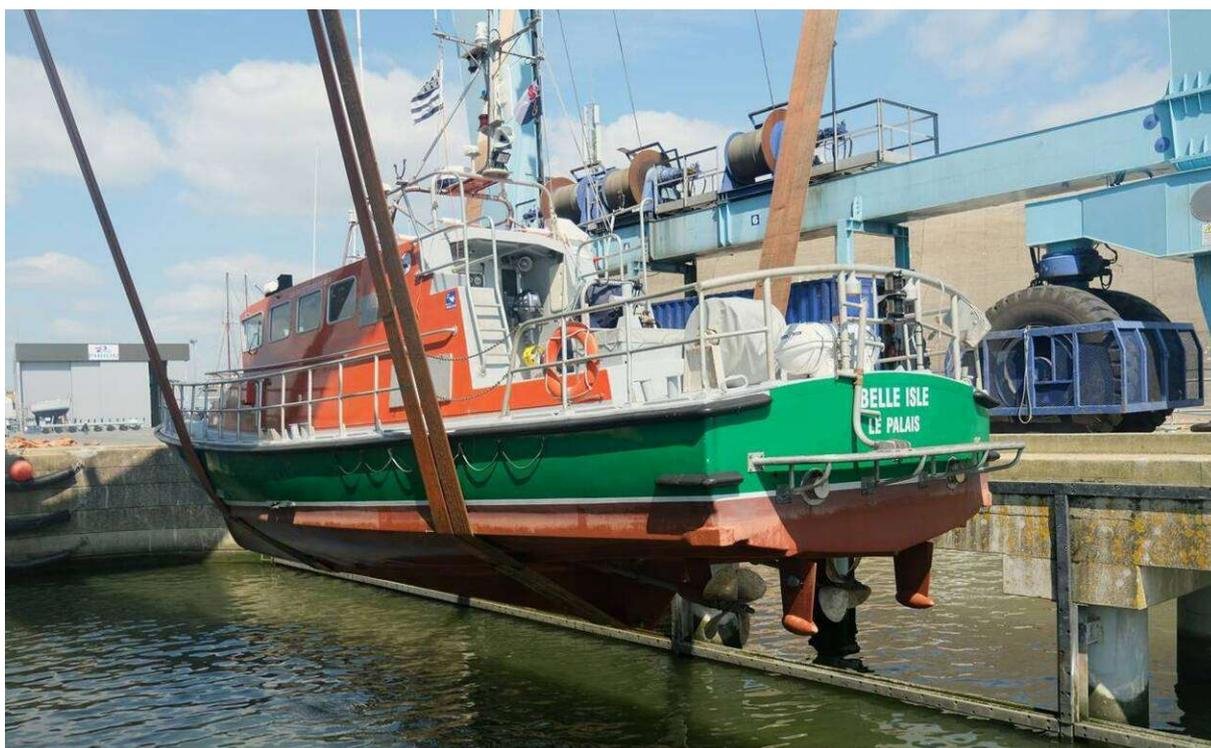
Le SNS 096 « Belle Isle » à sa sortie de l'eau à Lorient. Caractéristiques : poids à vide, 24 tonnes ; longueur, 17,60 m ; largeur, 4,40 m, deux moteurs de 400 chevaux. | OUEST-FRANCE
