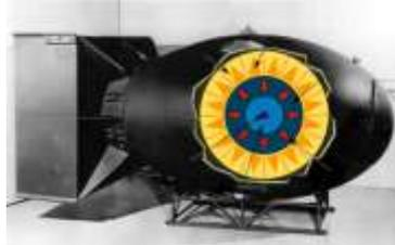
Au centre en noir l'initiateur à neutrons entoure le plutonium, en poudre très fine, qui sera compressé par l'onde de choc créée par le dispositif pyrotechnique (jaune et orange) alternant explosif lent et explosif rapide
