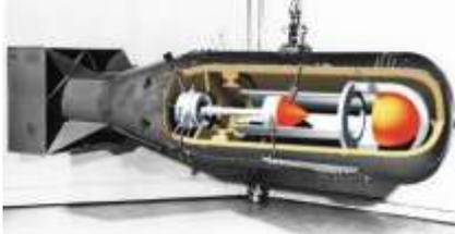
Le cône d'U235 est projeté grâce un dispositif pyrotechnique, à gauche de la coupe, et vient compléter la sphère d'U235 en s'emboîtant formant ainsi une sphère de masse supérieure à la masse critique
