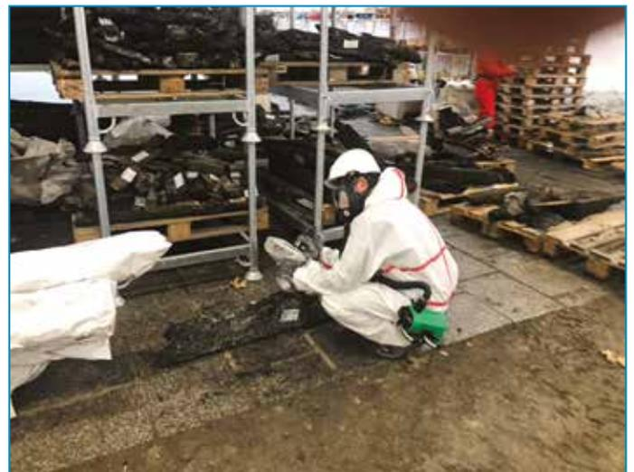
Fig. 3 : Analyse par fluorescence X (XRF) portable des bois sur le chantier de restauration. © P Dillmann.
