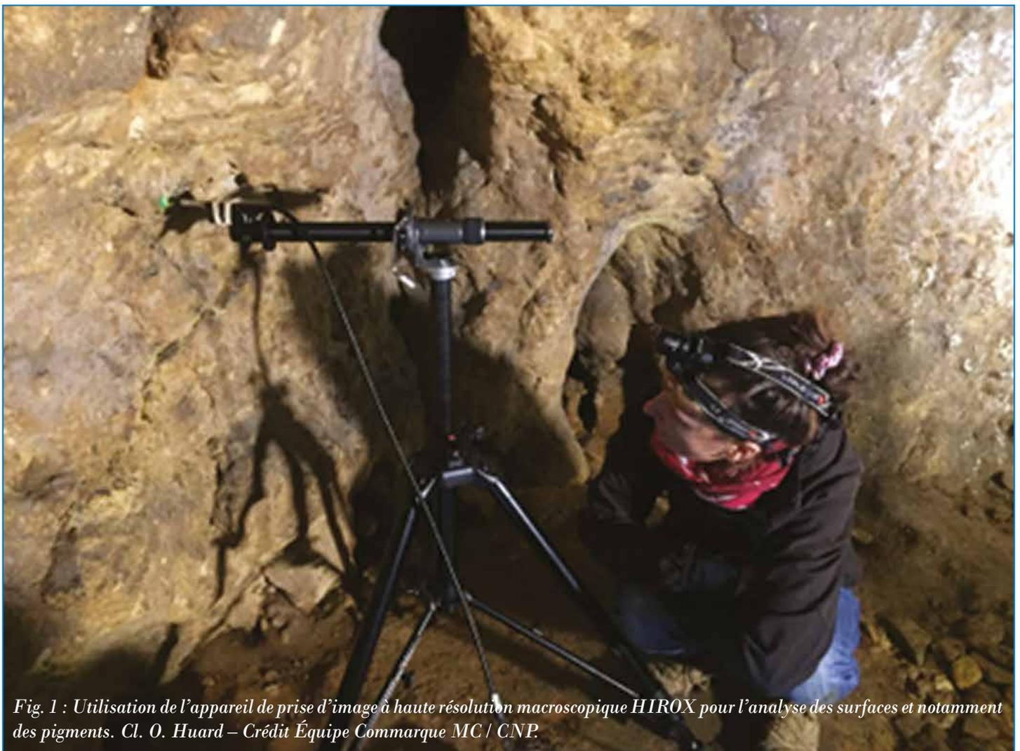
Fig. 1 : Utilisation de l'appareil de prise d'image à haute résolution macroscopique HIROX pour l'analyse des surfaces et notamment des pigments. Cl. O. Huard – Crédit Équipe Commarque MC / CNP.
