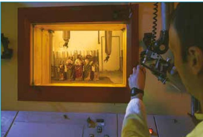
Fig. 2 : Traitements de désinsectisation par irradiation gamma de statues en bois polychromé dans la cellule d'irradiation. Source : @ARC-Nucléart.
