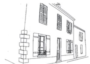
Les ouvertures sont ordonnancées suivant l'axe horizontal et vertical
