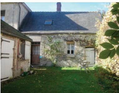
La construction forme un parallélogramme rectangle de plain-pied, surmonté d'un toit à deux pans, avec des pentes comprises entre 35° et 45° ; les souches de cheminée sont généralement en brique.
