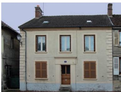
De plan rectangulaire, elle comprend deux, exceptionnellement trois, niveaux, auxquels s'ajoutent des combles souvent aménagés. D'une hauteur sous gouttière entre 8 et 9 mètres, elle est surmontée d'un toit à deux pans droits à 40 à 50°.
