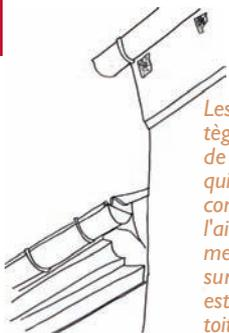
*Les corniches protègent les chevrons de la charpente qui ne doivent pas, comme ici, rester à l'air libre ; elles permettent aussi d'assurer un raccord esthétique entre la toiture et le mur*
