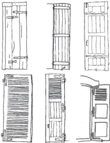
Six types de volets couramment rencontrés à Ermenonville. De haut en bas et de gauche à droite : volet plein, à double articulation avec ferrures artisanales, volet plein en position ouverte (les barres d'assemblage sont visibles), volet plein avec jours ; volet totalement persienné ; volet droit persienné sur le tiers supérieur ; volet arqué, adapté à l'encadrement de la baie qu'il occulte
