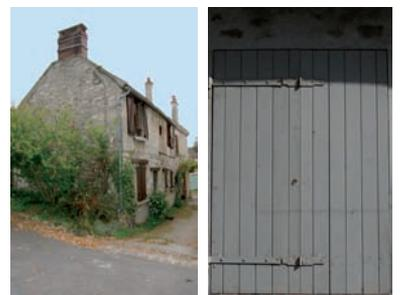
Bois, tuile plate et moellon de grès ou de calcaire, à l'origine toujours enduits en totalité, sont les principaux matériaux de construction des maisons rurales.
