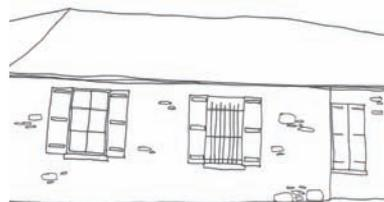
Les maisons rurales, maçonnées avec des moellons de grès ou parfois de calcaire, sont traditionnellement enduites. Seules quelques têtes de moellons peuvent être visibles en façade
