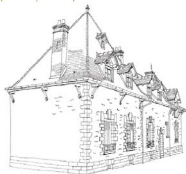
Les débords de toits et la variété des matériaux des toitures (tuile plate ou mécanique, ardoise, zinc) sont caractéristiques des villas
