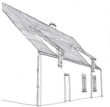
Les lucarnes dites à encavement (leur appui de fenêtre se trouve sous l'égoût de toiture) sont une caractéristique de la maison "de ferme"
