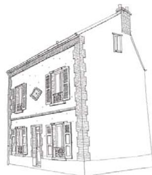
Les villas sont riches en modénatures (chaînages d'angles, bandeaux de façades, encadrements de fenêtres) de brique
