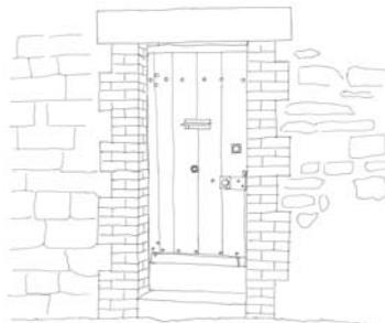
Portillon en bois surmonté d'un linteau en pierre posé sur des jambages en brique
