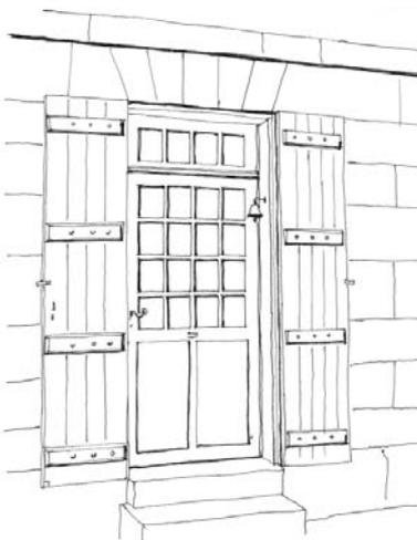
Porte d'entrée avec panneau vitré derrière petits bois ; imposte vitrée parfois surmontée d'une marquise ; volets en bois plein constitués de lames verticales assemblées par des barres horizontales sans écharpe
