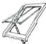
Chassis à tabatière appelé aussi vasistas, c'est la fenêtre de toit traditionnelle présente sur le bâti ancien, à cadre léger en tôle galvanisée dont l'ouvrant est à projection
