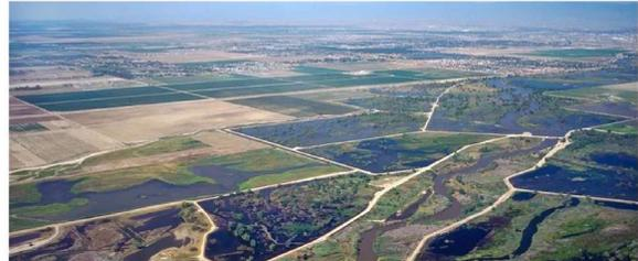
*Bassins d'épandage (infiltration) utilisés dans le comté de Kern, en Californie, à l'extrémité sud de la région de la vallée centrale pour recharger les aquifères utilisés pour les sources d'eau souterraine*
