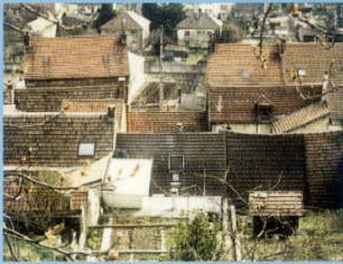
Elles sont généralement à 2 pans inclinés à 45°. Mais sur les constructions pavillonnaires de 1900-1950, les formes et les matériaux sont variés : tuile plate et zinc rarement, tuile mécanique et ardoise souvent. Les cheminées sont en pierre ou en brique.
