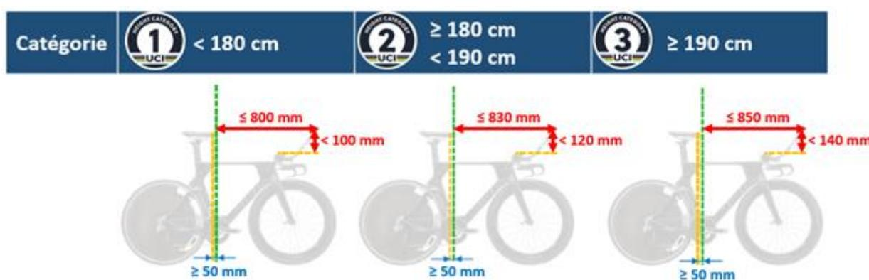
En outre, tous ensembles d'extensions fixes du guidon de contre-la-montre et supports d'avant-bras repose-coude doivent être conformes aux éléments suivants :
