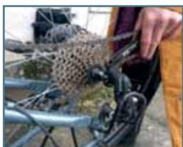
Si on débute absolument et qu'on n'a ni confiance, ni patience, il peut être utile d'avoir un ami ou d'aller dans un atelier vélo, notamment pour enlever et remettre la roue arrière. Il faut sortir la roue du cadre. Pensons à déclipser les freins. Se mettre à l'aise : sans pied d'atelier, retournons le vélo.
