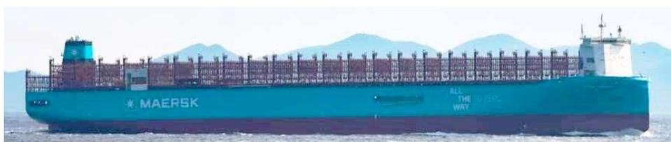
Ci-dessus, le tout nouveau navire **Astrid Maersk** construit par Hyundai Heavy Industries Co. Ltd à Ulsan a été repéré au large de Busan lors de ses essais en mer. (Photo : Jan Plug). Long de 351 m et large de 54 m pour un port en lourd de 189 508 t et une capacité de 19 000 EVP, il naviguera sous pavillon danois. On imagine l'inconfort de l'équipage face aux vagues dans le mauvais temps compte-tenu de la position du château sur le gaillard d'avant.
