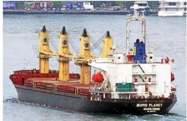
Le Skipper Planet est un vraquier construit en 1993 et Navigant sous le pavillon de Palau. D'une longueur de 157,5 m et d'une largeur de 25 m, son port en lourd est de 22 176 t.
