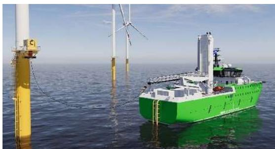
Dans le cas où le navire n'aurait pas accès à l'électricité pendant une courte période, le SOV 7017 E dispose d'une redondance complète et peut poursuivre ses opérations avec une propulsion diesel conventionnelle.
