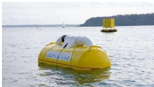
Le caisson cylindrique qui permet de produire de l'électricité en utilisant la force des vagues. (Photo : Ifremer)
