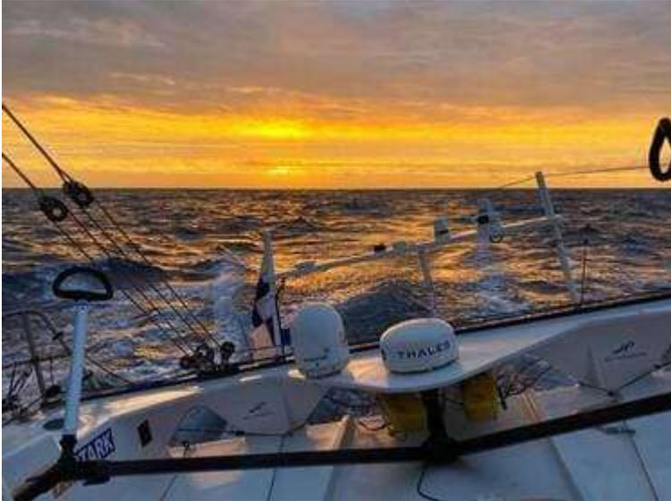
Le 6 janvier 2021, à bord du monocoque 60 pieds d'Ari Huusela, pendant le dernier Vendée Globe. À gauche l'antenne Inmarsat Fleet, plus encombrante que l'antenne Iridium Thales VesselINK 700, à droite. Même pour ce service « haut débit » (704 kb/s), Iridium fonctionne avec des antennes assez compactes et légères. | ARI HUUSELA
