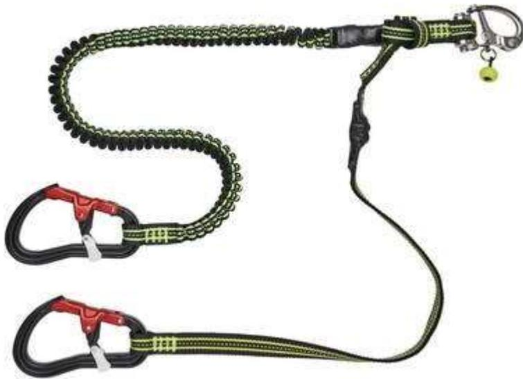
La nouvelle version de la longue double Proline'R de Wichard, toujours dotée d'un mousqueton à ouverture rapide côté harnais. Le brin court est toujours terminé par une boucle (« SmartLoop ») qui le rend amovible et permet éventuellement de l'utiliser seul – on a ainsi deux longes, une extensible de 2 mètres, et une courte de 1 mètre. Les témoins de surcharge sont protégés par un gainage noir. | WICHARD
