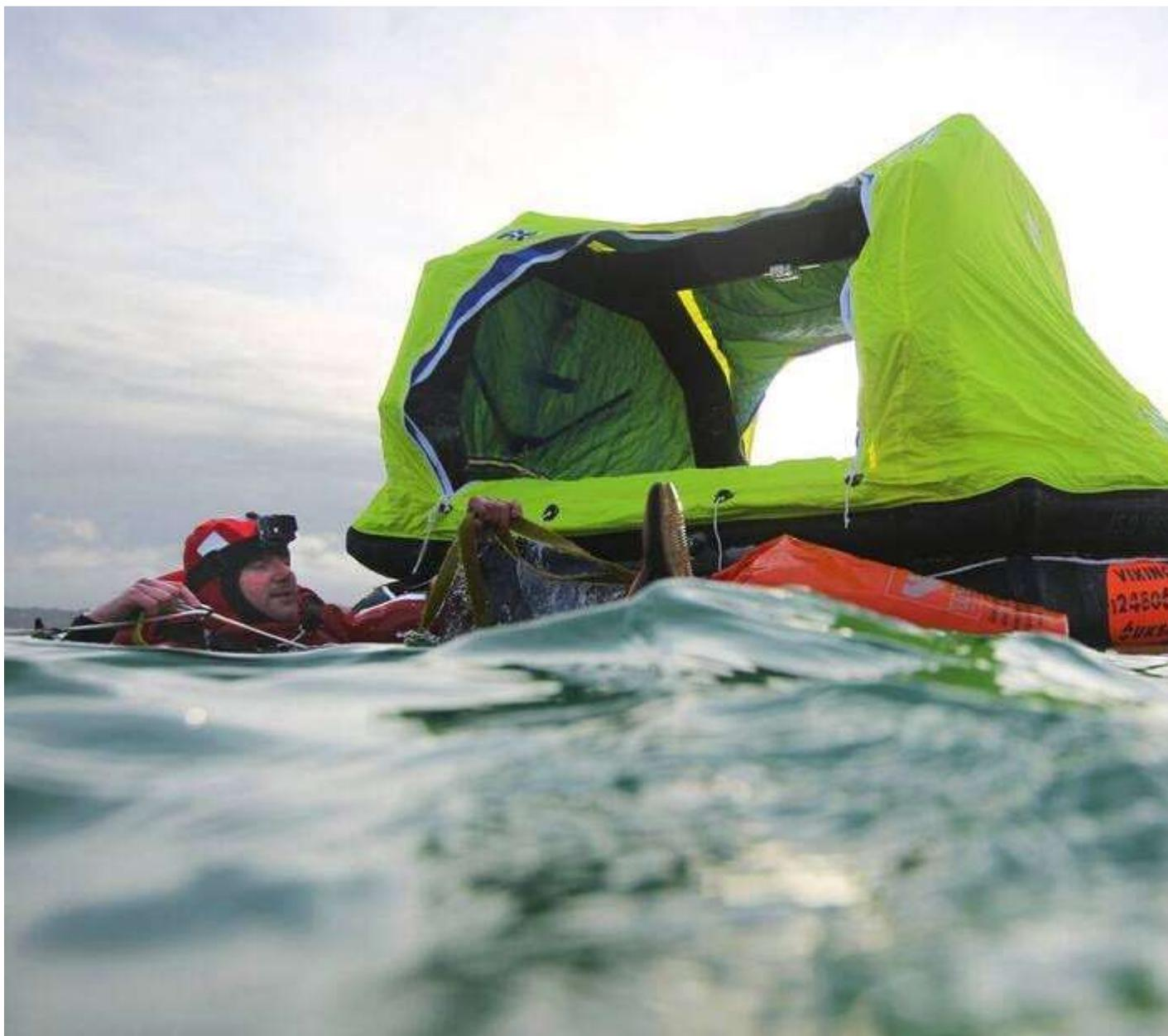
Il n'est pas forcément simple d'embarquer dans un radeau de survie quand on se trouve dans l'eau. Avec la panique, la fatigue, le froid... Il faut donc choisir un modèle doté d'une bonne rampe d'embarquement semi-rigide. (Ici un RescYou Pro de Viking, voir nos tests dans le numéro 589 du magazine mensuel, mars 2020.) | JEAN-MARIE LIOT
