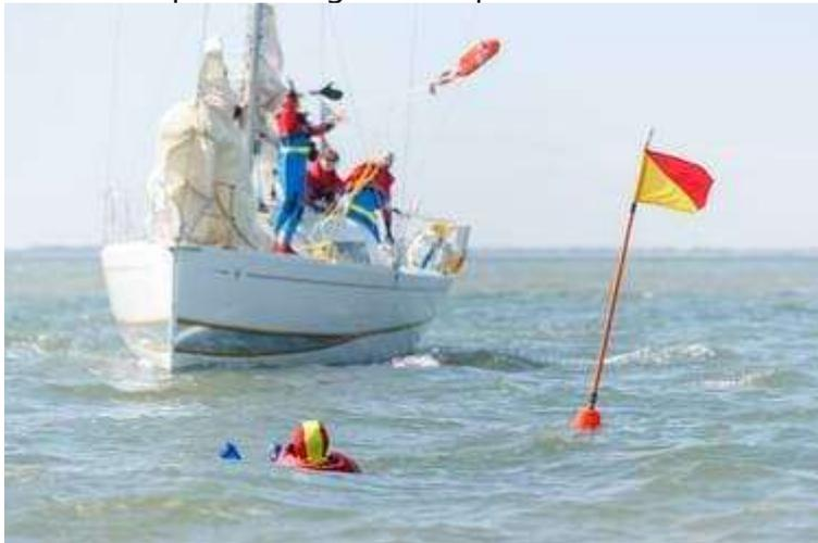
La bonne vieille perche IOR reste très efficace pour bien baliser l'emplacement d'une chute à la mer. Il faut préférer les modèles rigides. Ici à l'arrière-plan sur le Sun Fast 3200, on lance un harnais flottant frappé sur un filin, pour la récupération de l'homme à la mer. | TANGI LE BIGOT
