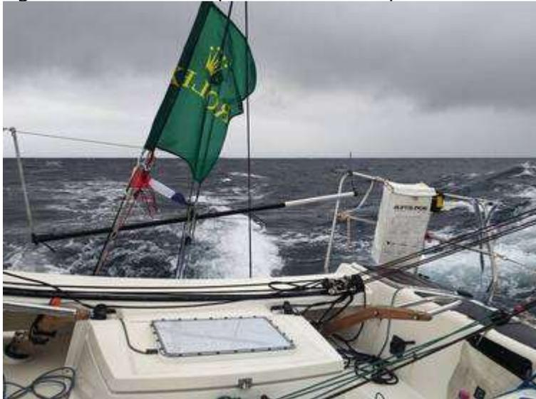
À bord du Sun Fast 3200 d'Henri Laurent (le développeur de l'application SailGrib). Installation custom pour antenne Starlink standard, fixée à plat sur le caisson arrière du cockpit. | HENRI LAURENT
