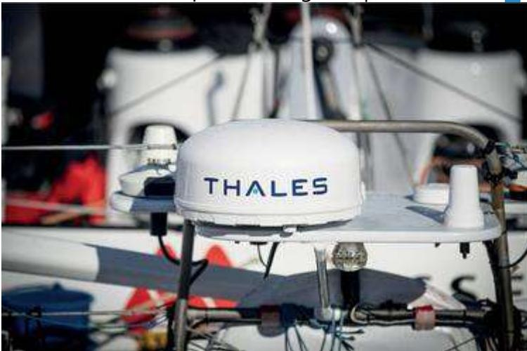
Gros plan sur la même antenne Thales VesselINK 700 pour service Iridium Certus 700, toujours sur un monocoque 60 pieds Imoca. | ELOI STICHELBAUT / POLARYSE / IMOCA
