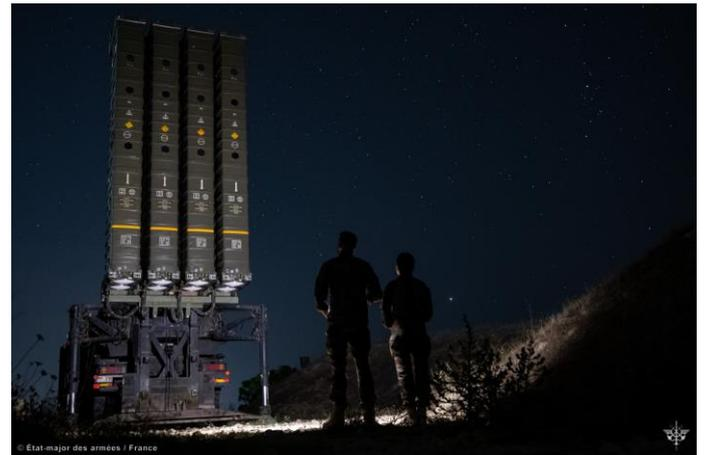
Dans ce cadre un détachement dispose d'une section Mamba complète composée d'une conduite de tir (Module d'Engagement - ME) connectée à plusieurs modules de lancement terrestre (MLT) capables de mettre en œuvre jusqu'à huit missiles sol-air, pouvant atteindre un objectif à plus de 100 km.
