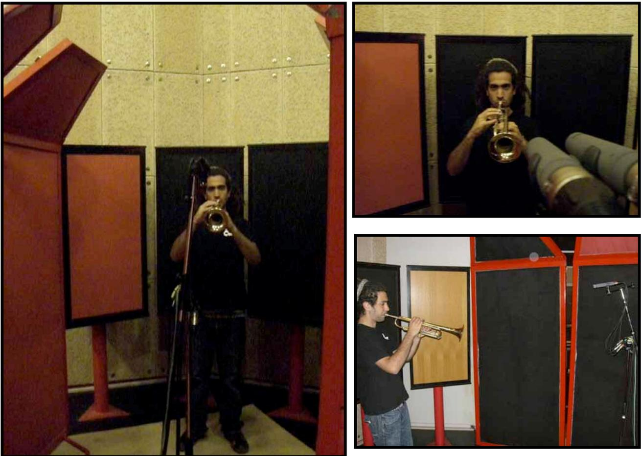
**Figure 26** : Photos du placement microphonique lors de la prise de son de la trompette.
