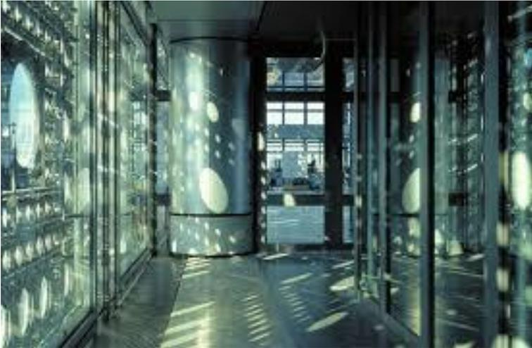
L'ouverture des diaphragmes est réajustée toutes les heures pour s'adapter à la luminosité extérieure et créer un jeu de lumière à l'intérieur du bâtiment ; les volets permettent ainsi d'observer sans être vu.
