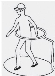
Figure 5.5 : schéma de principe de tapis Omni : le marcheur se tient debout au milieu, entouré par l'arceau, tout en glissant les pieds sur le socle légèrement concave
