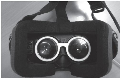
**Figure 4.5 :** cache en plastique, fait par imprimante 3D et dimensionné progressivement pour encadrer le champ de vision effectif vu par l'observateur
