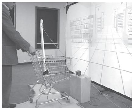
**Figure 1.6 :** déplacement virtuel grâce à un chariot, contrôlé comme un joystick
