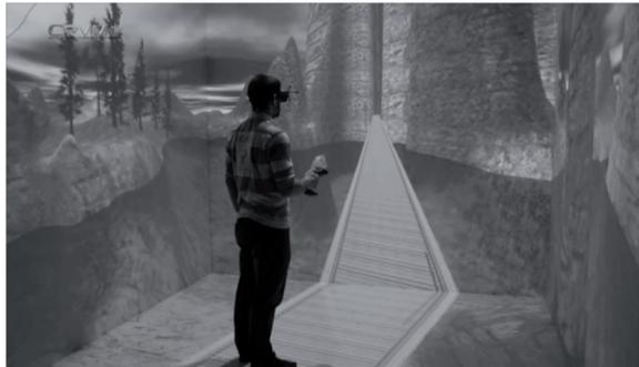
**Figure 9.1 :** un sujet immergé dans le CAVE du CRVM. Le dispositif est constitué de 4 écrans rétro projetés (le sol et 3 écrans verticaux). Dans cette expérimentation, le sujet doit marcher sur une passerelle au-dessus d'un canyon.
