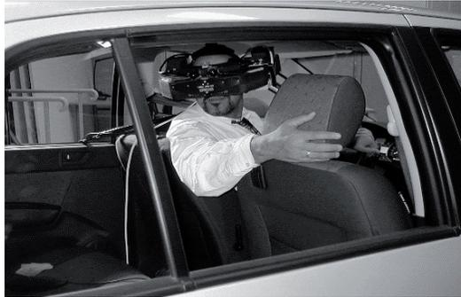
**Figure 10.3 :** vision de l'intérieur de véhicule avec un visiocasque à large champ de vision
