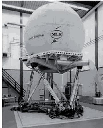
**Figure 5.9 :** cabine de simulateur de vol à 6 ddl
