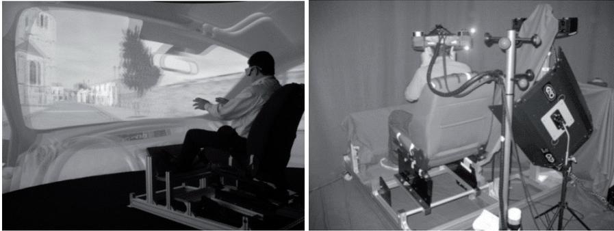
**Figure 10.5:** observateur devant un écran cylindrique et avec un visiocasque VR ou AR
