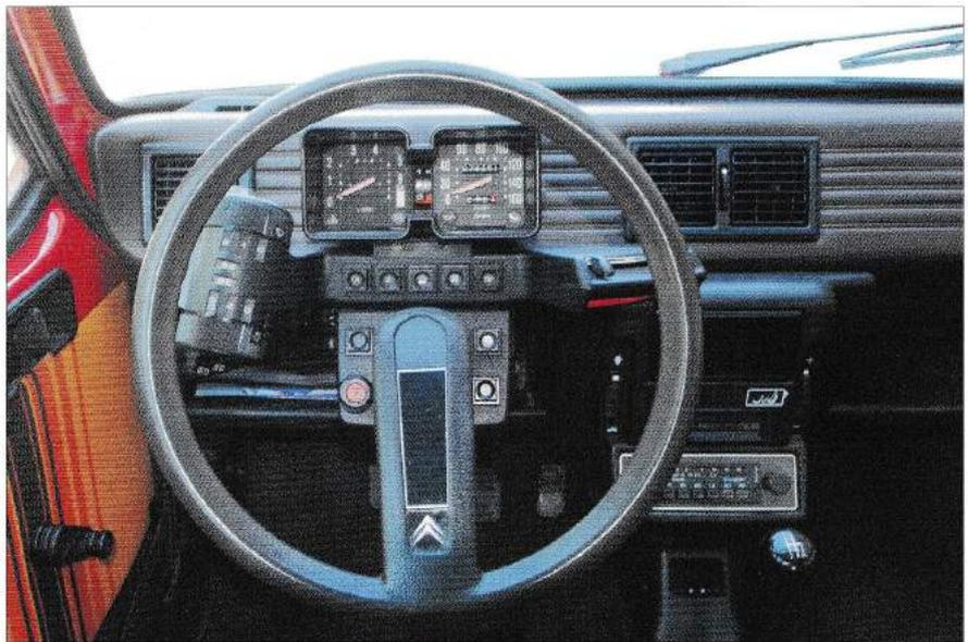
A l'intérieur, le poste de conduite de la Super X se différencie des autres Visa uniquement par la présence d'un compte tours en lieu et place de la montre et d'un nouvel enjoliveur de la branche du volant. D'autre point comme le remplacement des interrupteurs noirs par des interrupteurs éclairants, nouveau graphisme du compteur kilométrique... sont apportés à toute la gamme Visa.
