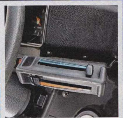
À droite du volant, ce satellite rectangulaire regroupe les commandes de la ventilation et du chauffage. Pas très joli, mais bien placé et pratique à utiliser.
