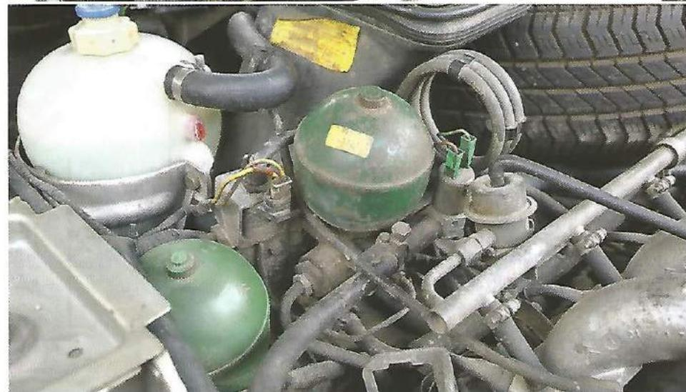
Dans le sens des aiguilles d'une montre: installé sur le plancher droit, accessible via une découpe dans la moquette, le calculateur est celui des premières XM. Sous le capot, le filtre à essence disparaît, remplacé par le régulateur de raideur et sa sphère, l'électrovanne de commande et les tuyaux de gros diamètre de l'Hydractive. Son homologue arrière est aussi installé côté droit, sous la caisse.
