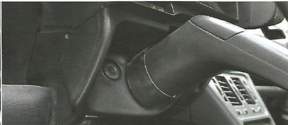
Ci-dessus, la branche du volant raccourcie permet d'adapter le boîtier du capteur de direction. Hélas vide sur l'auto essayée.
