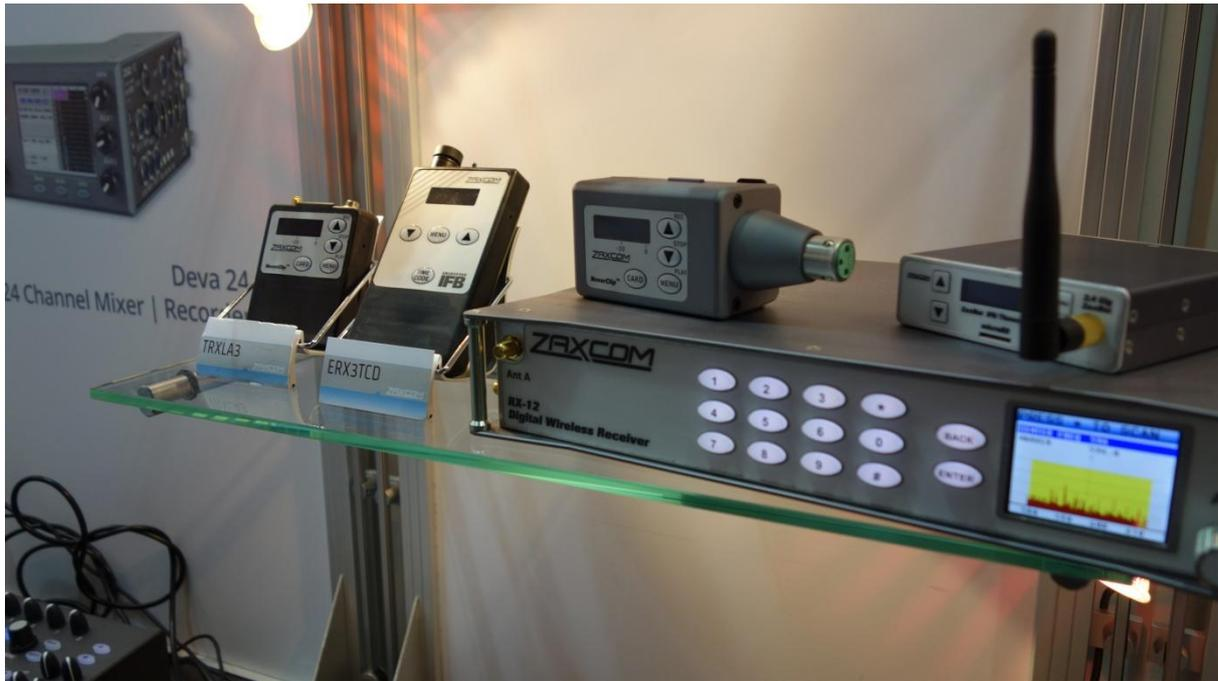
Le Deva 24 enregistre 24 pistes sur trois médias simultanés : deux cartes flash et un SSD. La face avant de la machine est amovible, et peut être positionnée à n'importe quel endroit de la sacoche ou de la roulante, reliée à l'unité centrale par un seul câble.
