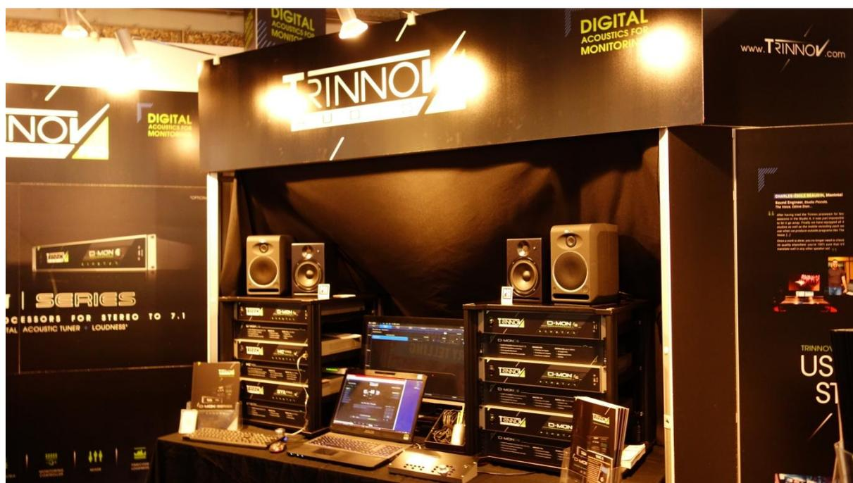
En plus de proposer un traitement actif de l'acoustique (amélioration de la réponse en fréquence, remise en phase des enceintes...) le D-MON permet également un contrôle de monitoring poussé (routing des entrées/sorties, mixeur interne...).
