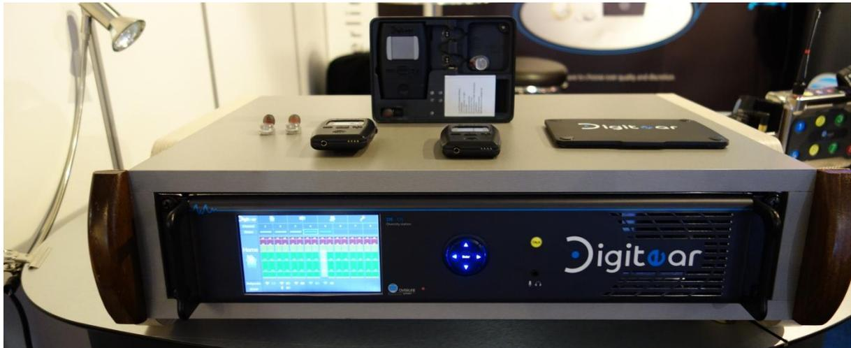
Le DE PS relaie alors l'information vers l'oreillette en Bluetooth (V4.0 / 2,4Ghz) en utilisant le codec audio APT-X. Ce boîtier, équipé d'un micro interne et d'une touche talkback, permet de régler l'oreillette (volume, choix du canal, choix du micro, gain du micro, connection Bluetooth...) et peut aussi déclencher un GPO. Il a une autonomie de 8 heures.
